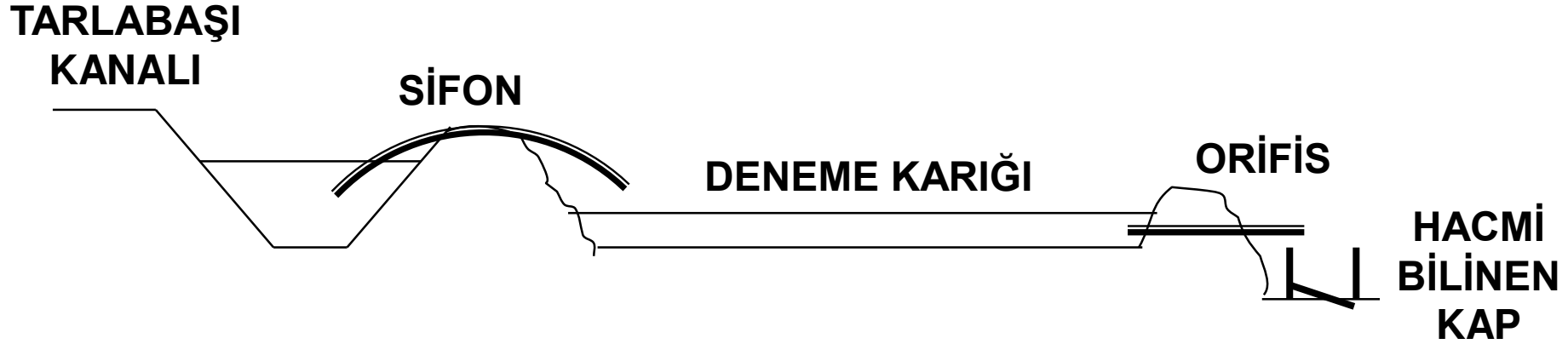
Şekil 7. İnfiltrasyon testlerinin yapıldığı deneme kariğının tertibi ve kesiti
