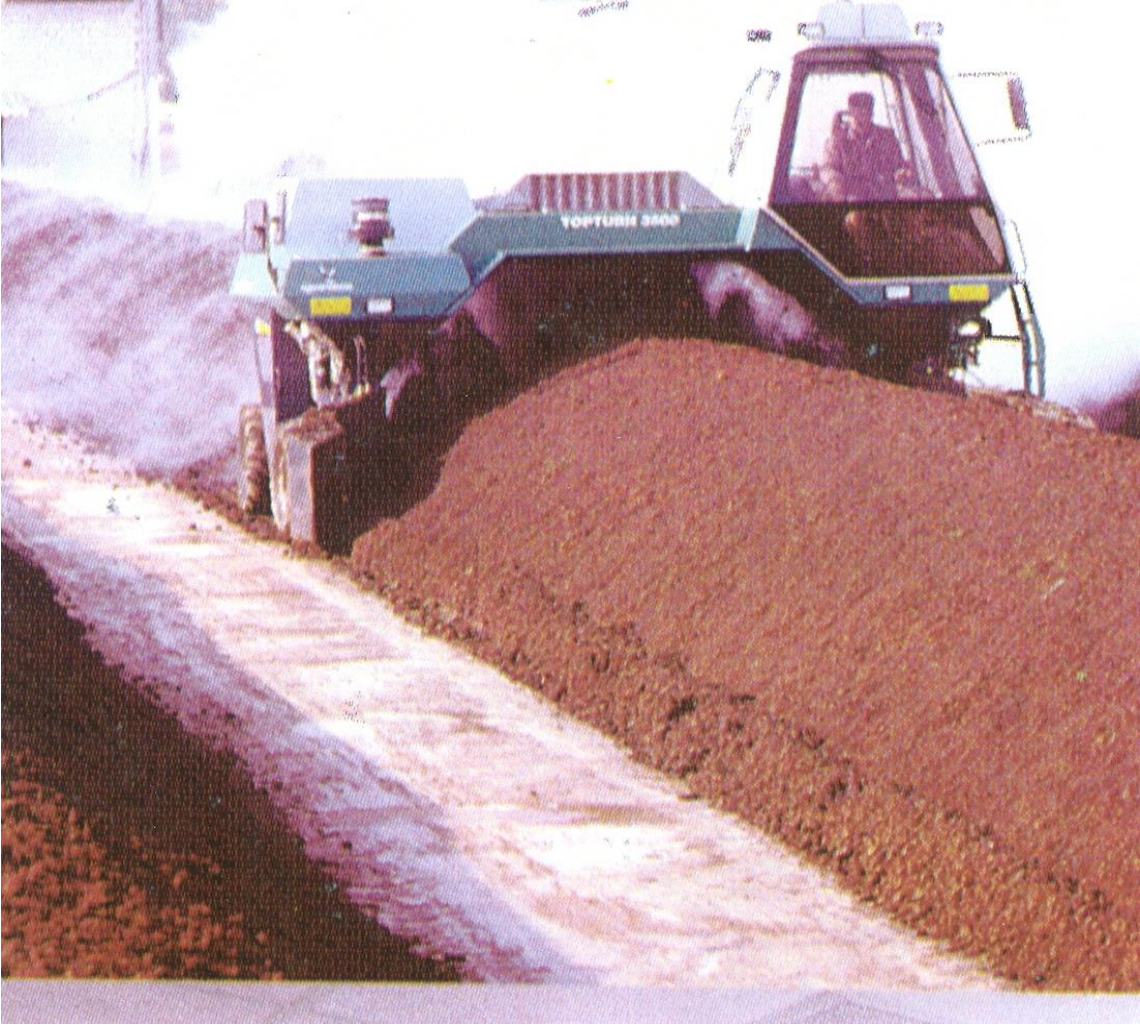
Şekil 8. Arabalı karıştırma sisteminde fermentasyon süresince dışkıların karıştırılması
