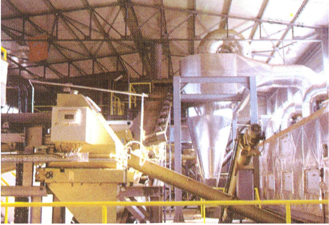
Şekil 9. Kompostlama sırasında organik gübrenin kırma, öğütme ve peletleme proseslerinden geçirilmesi
