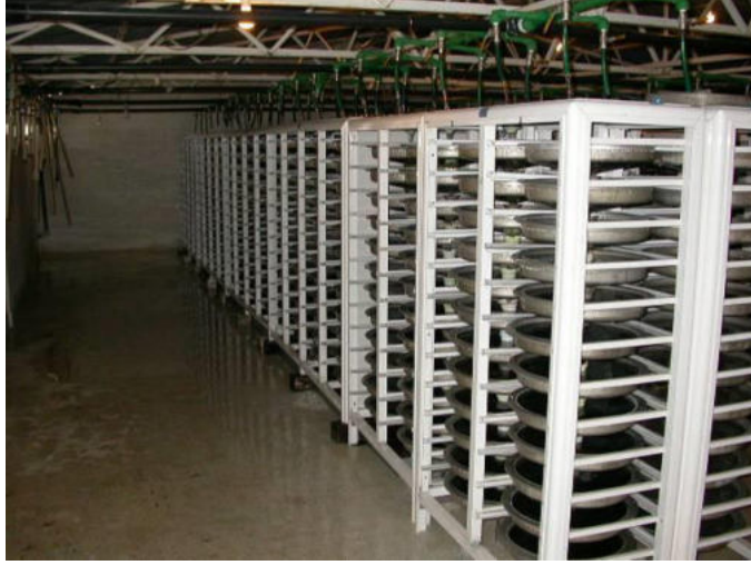
Resim 3.3: Dolap tipi kulukalk
