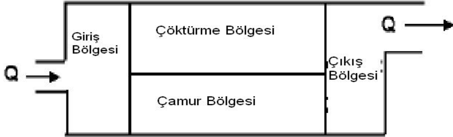
Şekil 7.2 Çöktürme havuzunun fonksiyonel bölgeleri (Fornshell 2001)
