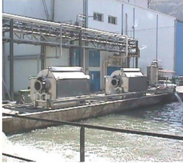
Şekil 7.3. Mekanik filtrasyonda kullanılan tambur filtre (Anonim 2011a)
